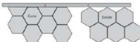
Figura 02. Modo de encaixe para à execução.
