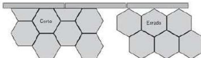
Figura 02. Modo de encaixe para à execução.
